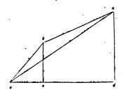
clinationi che volendo saper quant'è da b all' a e quant' e la sua inclinatione essendo in c per le cose dette sapremo quanto è a d et quanto è b e et quanto è c d et c e, e se separatamente operaremo come si è detto sapremo quanto è b a et quant è la sua inclinatione sopra l'horizonte si come per esempio, facendo li triangoli simili f h i all a c d et g h k al b c e congiungendo g f e di quante parte sara f g di quelle che sono nelle h c, di tante sara a b di quelle che sono in c d
