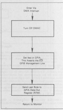
Figure 8. Send Last Byte Routine Flow Chart
