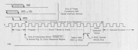
FIGURE 4 — MC6801 INTERRUPT ENTRY SEQUENCE
