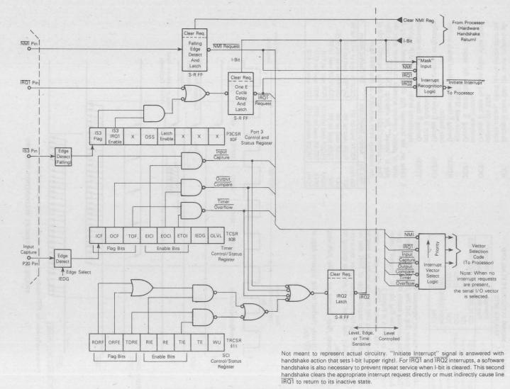
FIGURE 2 — CONCEPTUAL REPRESENTATION OF MC6801 INTERRUPT STRUCTURE
