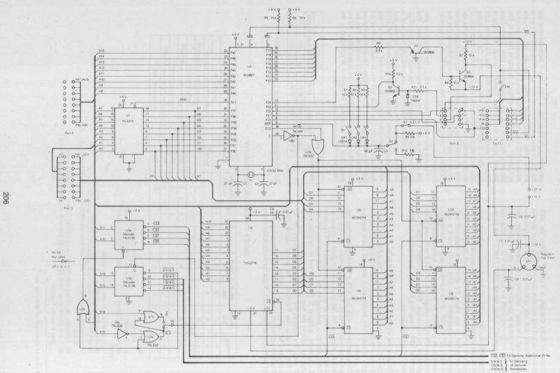
FIGURE 2 - MC6801 APB SCHEMATIC DIAGRAM
