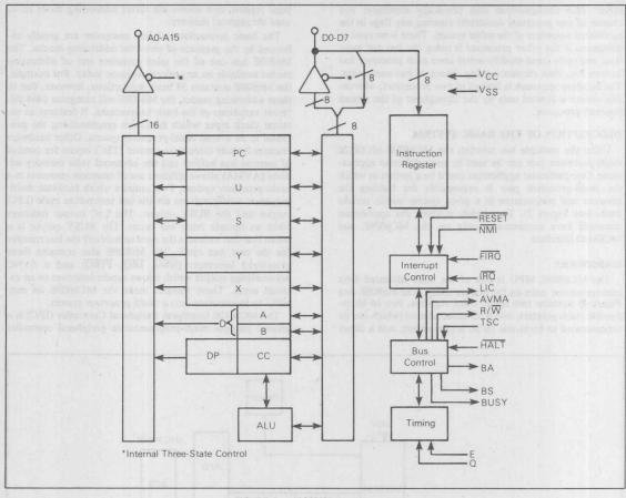
FIGURE 4 - MC6809E Block Diagram
