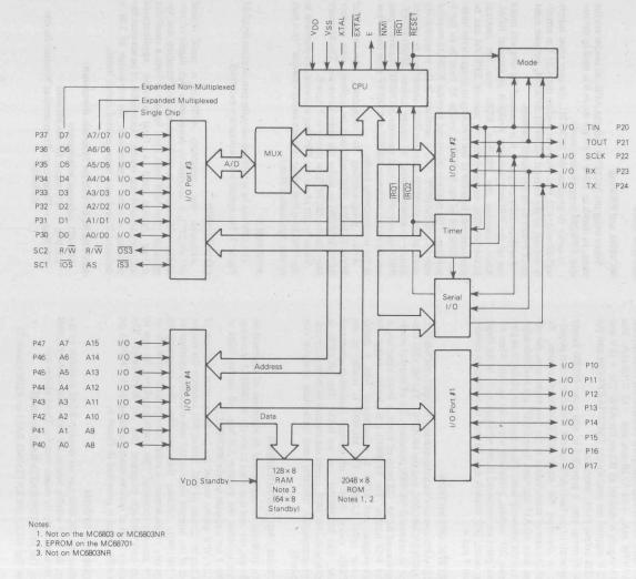
FIGURE 5 - MC6801 SINGLE CHIP MICROCOMPUTER
