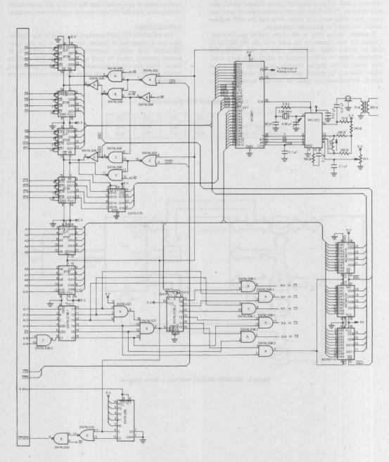
Figure 2. MC68000/MC6847 — Schematic Diagram
